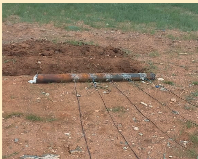
Рис. 6. Заряд ВВ с подключенными датчиками. Сурет 6. Датчиктер қосылған жарылғыш заряд. Figure 6. Explosive charge with connected sensors.
