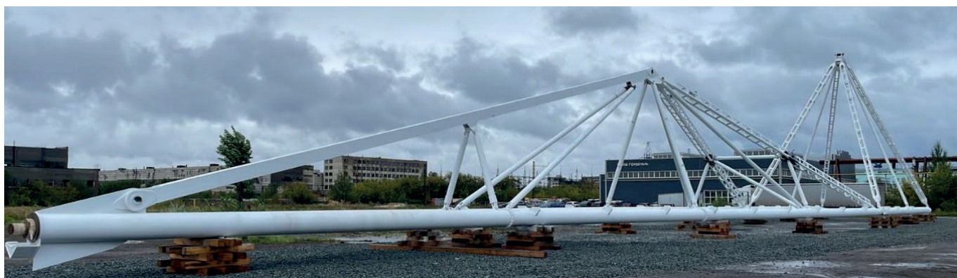
Рис. 4. Стрела экскаватора ЭШ 10/70 на площадке Производителя
