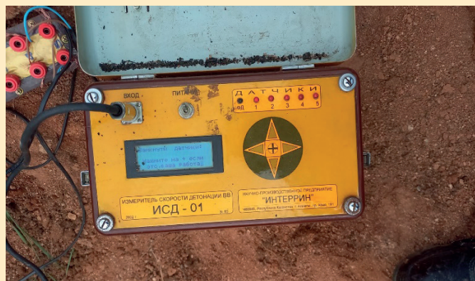
Рис. 5. Измеритель скорости детонации ИСД-01. Сурет 5. Детонация жылдамдығын өлшегіш. Figure 5. Knock velocity meter.
