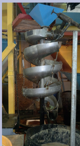
Рис. 3. Винтовой сепаратор. Сурет 3. Винтті сепаратор. Figure 3. Screw Separator.
