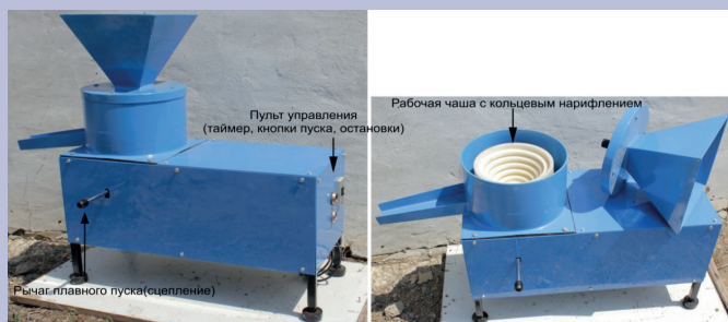
Рис. 5. Виброцентробежный чашевый аппарат. Сурет 5. Дірілді ортадан тепкіш табақшалы аппарат. Figure 5. Vibrating centrifugal bowl machine.
