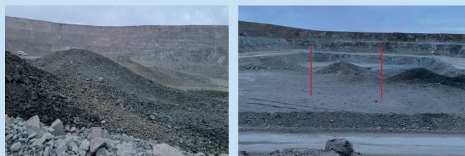
Рис. 5. Влияние электронных средств инициирования на контроль разбуживания руды.
