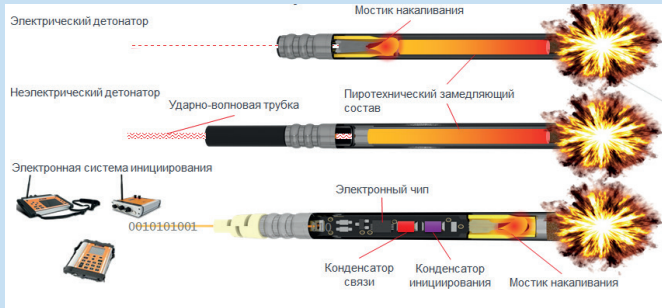
Рис. 1. Конструкции различных видов средств инициирования.
