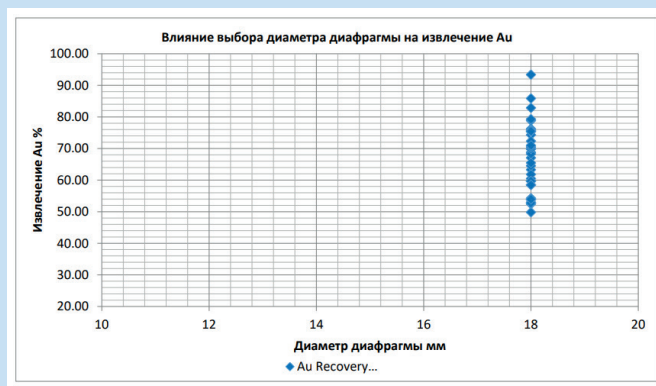
Рис. 3. Влияние выбора размера диафрагмы на технологические показатели извлечения.
