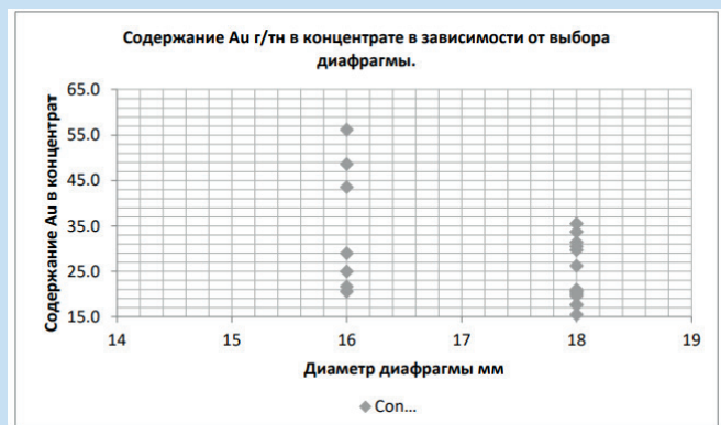
Рис. 4. Влияние выбора размера диафрагмы на технологические показатели содержания.
