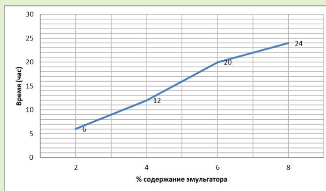
Рис. 2. Зависимость срока хранения эмульсии от процентного содержания эмульгатора в составе. Сурет 2. Эмульсияның сақтау мерзімінің құрамындағы эмульгатордың пайыздық мөлшеріне тәуелділігі.
