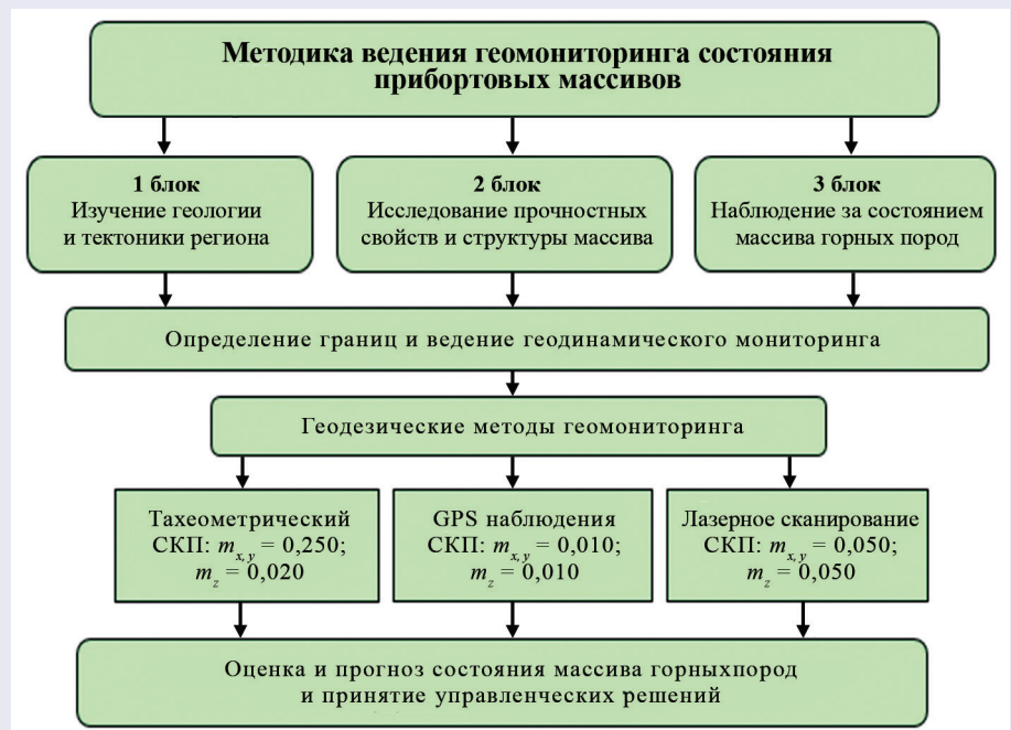
Рис. 2. Схема комплексной методики ведения геомониторинга. Сурет 2. Геомониторинг жүргізудің кешенді әдістемесінің схемасы. Figure 2. The scheme of the complex methodology of conducting geomonitoring.
