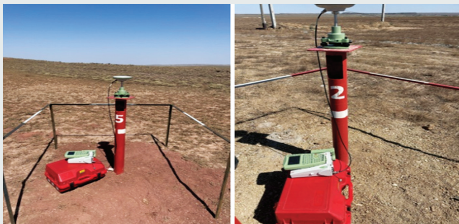
Рис. 2. Применение глобальной навигационной спутниковой системы при проведении геодинамического мониторинга.
