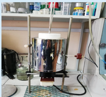
Рис. 1. Реактор для обжига. Сурет 1. Қуыру реакторы. Figure 1. Roasting reactor.
