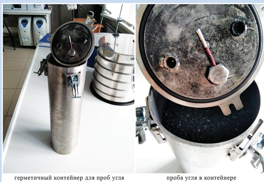
Рис. 1. Пробы угля в герметичной емкости.
