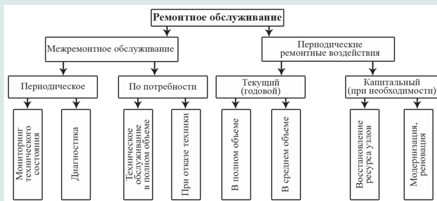
Рис. 5. Структура ремонтного обслуживания горной техники. Сурет 5. Тау-кен техникасын жөндеу қызметінің құрылымы. Figure 5. Structure of mining equipment repair services.
