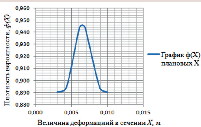
Рис. 4. График плотности вероятности плановых деформаций, имеющих нормальное распределение.
