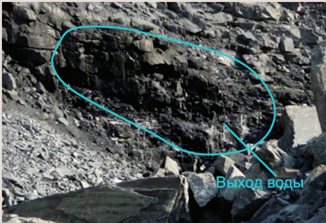
Рис. 1. Сосредоточенный выход воды в трещиноватых скальных породах на борту карьера. Сурет 1. Карьердің бортында жарылған жартасты жыныстарда судың шоғырланған шығуы. Fig. 1. Concentrated water output in fractured rocks on board the quarry.
