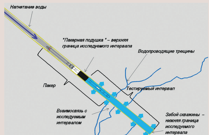
Рис. 5. Нагнетание с помощью одинарного пакера. Сурет 5. Дара пакердің көмегімен айдау. Fig. 5. Single packer injection.
