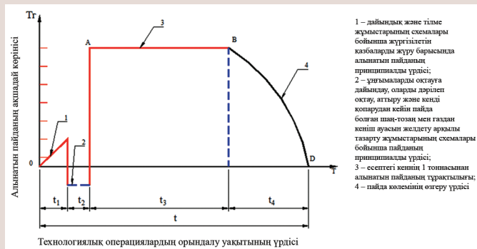
Сурет 1. Этажды еріксіз қопарып қазу жүйесімен кен өндірудегі технологиялық операциялардың орындалу реті мен олардан алынатын пайданың принципалды динамикасы.
