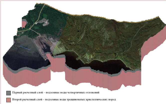
Рис. 7. Схема геофильтрационной модели в аксонометрии, берег Баренцева моря. Сурет 7. Аксонометриядағы геофильтрациялық модель схемасы, Баренцев теңізінің жағасы. Fig. 7. Planned digital model based on CMS.
