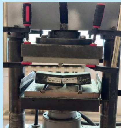
Сурет 4. ИП-100 сынақ пресімен тампонаждық цемент тасын иілуден кейінгі нәтижесі.
