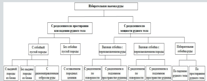
Рис. 5. Систематизация технологий разделения руды и породы при разработке рудных месторождений.
