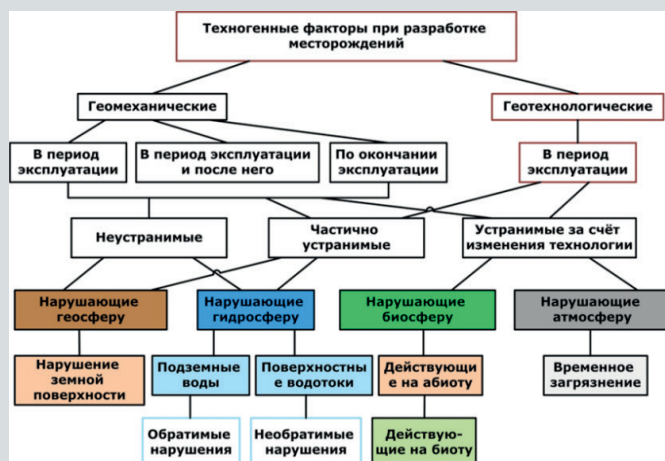
Рис. 6. Систематизация техногенных факторов горного производства по [1].
