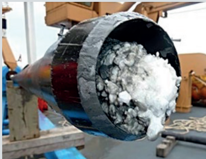
Сурет 1. Құбырөткізгіштегі гидрат түзілімдері.
