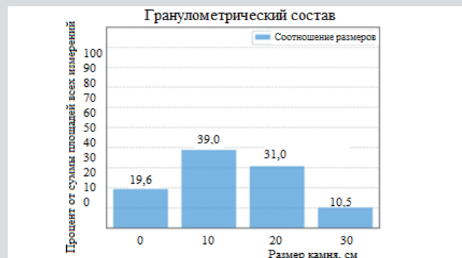
Рис. 2. Результаты расчетов гранулометрического состава пород в проходческом забое в программном обеспечении Pikelema CVision.PitFace.
