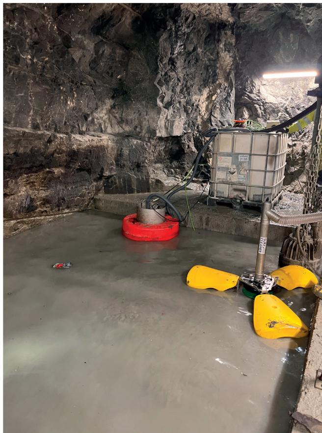
**Скиммер устанавливается непосредственно в первичном отстойнике использованной воды**
