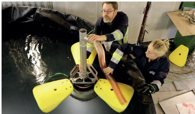
**Плавающий скиммер – компактное устройство для улавливания и сепарации нефтепродуктов**
