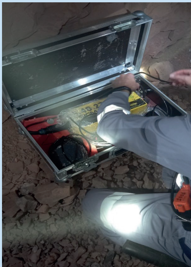
Рис. 2. Установка станции для сейсмомониторинга Sigma 4+.
