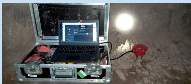
Рис. 4. Установка геофонов на почве выработки и подключение их к сеймостанции.
