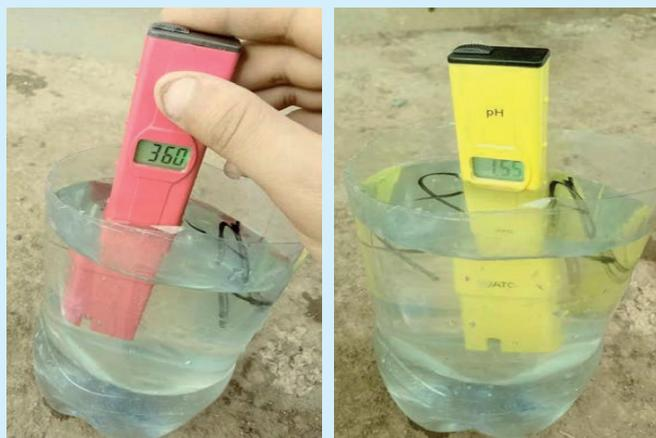
**Рис. 2. Измерительные приборы: а – ОВП-метр; б – рН-метр.**
