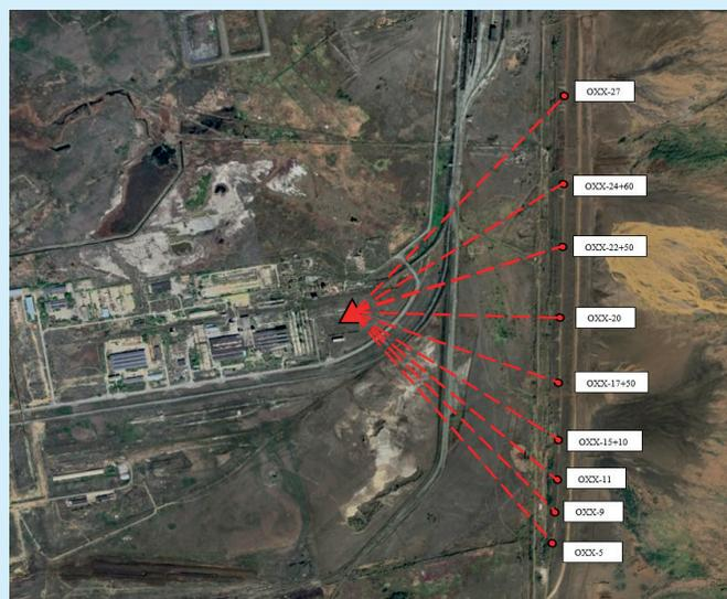
**Рис. 4. Схема ориентирования тахеометра на профильных линиях основной дамбы на телевизионную вышку.**
