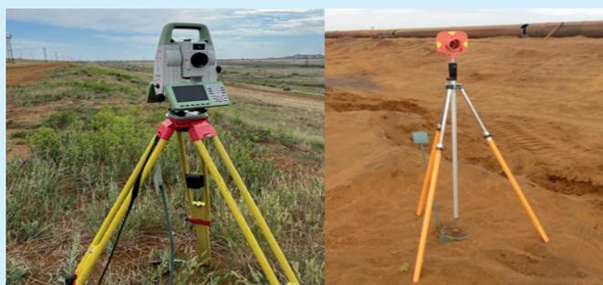
**Рис. 3. Электронный тахеометр с оптическим отражателем.**
