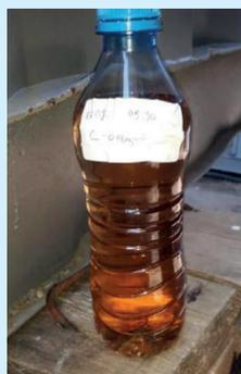
**Рис. 3. Проба с активированным выщелачивающим раствором после обработки раствора в биореакторах установки БОЖ.**
