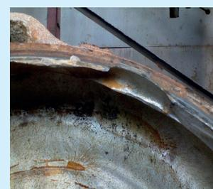
**Рис. 3. Износ корпуса грунтового насоса 8Гр-8.**
