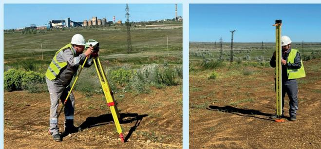
**Рис. 6. Нивелирование цифровым нивелиром и инварной рейкой.**
