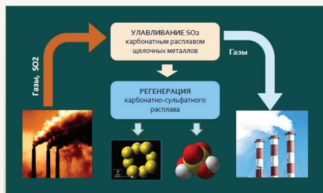
Рис. 2. Концептуальная схема глубокой очистки отходящих газов ТЭЦ от \text{SO}_2 и \text{NO}_x .
