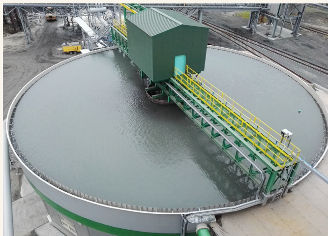
Рис. 1. Высокоскоростной сгуститель HRT-32 на Полтавском ГОКе.
