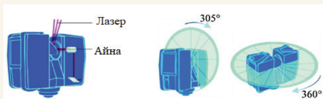
Сурет 1. Лазерлік сканердің тік және көлденең айналуы.
