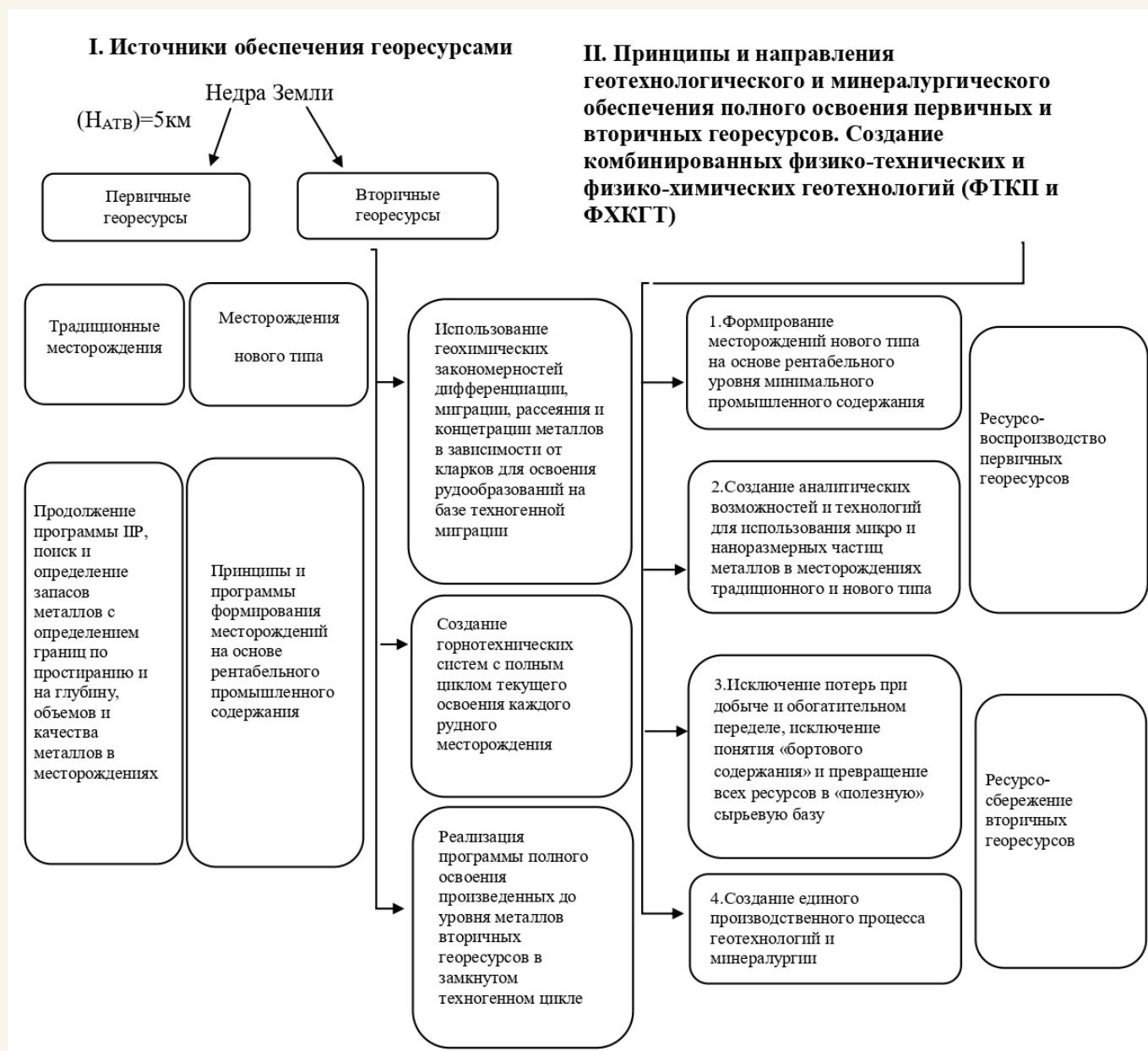
Рис. 2. Классификация технологических принципов полного освоения первичных и вторичных георесурсов в замкнутом природно-техногенном цикле и в управляемом режиме.
