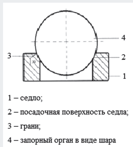
Рис. 5. Шаровой клапан углубленной посадки.
