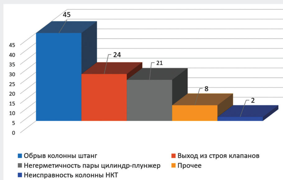
Рис. 4. Причины отказов штанговых установок. Сурет 4. Штангалық қондырғылардың істен шығу себептері. Figure 4. Reasons for failures of rod installations.
