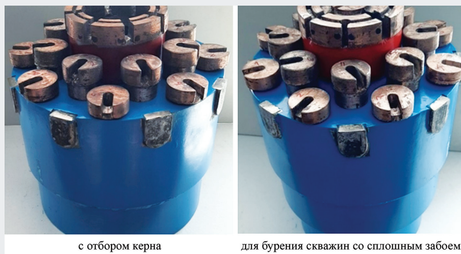
Рис. 2. Алмазные бурильные головки с гидроструйным эффектом разрушения пород диаметром 215,9 мм. Сурет 2. Диаметрі 215,9 мм тау жыныстарының бұзылуының гидроағынды әсері бар алмас бұрғыларының бастиктері. Figure 2. Diamond drill heads with hydrojet effect of rock destruction with a diameter of 215.9 mm.
