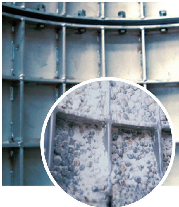
**Рис. 5. Внутренняя облицовка барабана**
