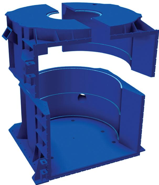
**Рис. 3. Корпус мельницы**
