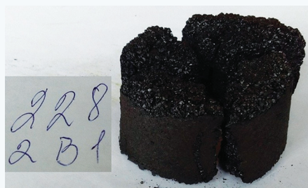
Рис. 3. Вид пластометрического полукокса из угля пласта 2B1. Сурет 3. 2B1 көмір қабатынан жасалған пластометриялық жартылай кокстың түрі. Figure 3. Type of plastometric semi-coke from coal formation 2V1.
