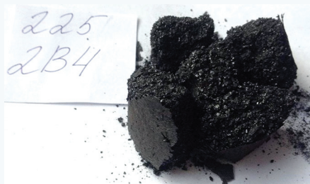
Рис. 6. Вид пластометрического полукокса из угля пласта 2B4. Сурет 6. Пластометриялық жартылай окстың қабат көмірінен жасалған түрі 2B4. Figure 6. Type of plastometric semi-coke from coal formation 2V4.
