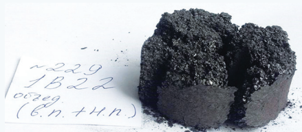
Рис. 2. Вид пластометрического полукокса из угля пласта 1B22. Сурет 2. 1B22 көмір қабатынан жасалған пластометриялық жартылай кокстың түрі. Figure 2. Type of plastometric semi-coke from coal formation 1V22.
