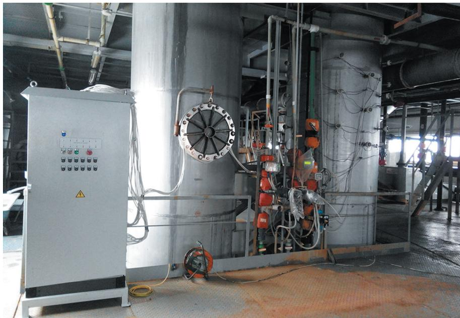
**Рис. 4. Комплект ультразвуковых излучателей AlexPulse HO – 330, установленных на технологическом трубопроводе.**
