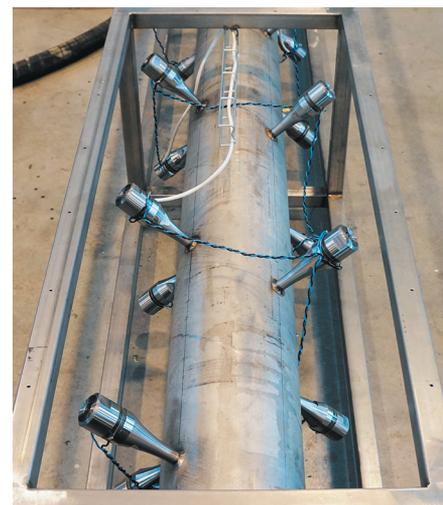
**Рис. 3. Контактные ультразвуковые излучатели AlexPulse HO – 407.**
