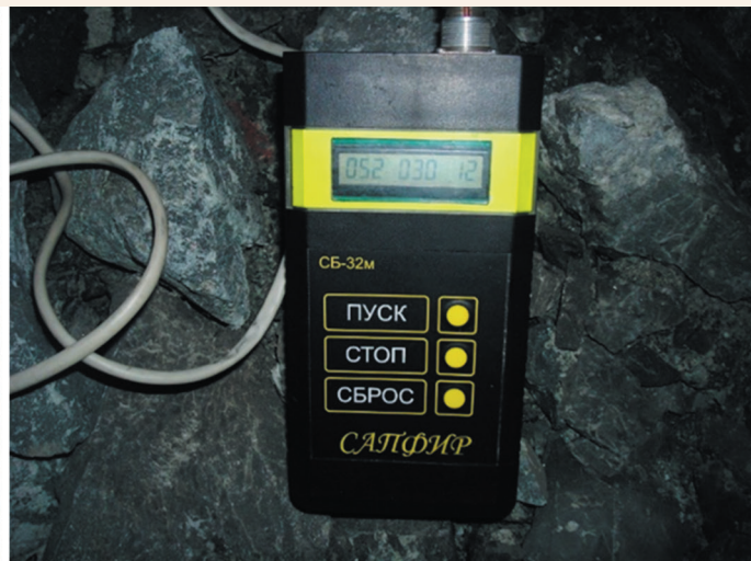
Сурет 1. Тау-кен соққыларын СБ-32 (М) Сапфир құрылғысымен өлшеу.
