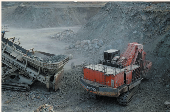
Сурет 2. Lokotrack MAF210 мобильді пластиналы қоректендіргішіне EX-3600E экскаваторымен кенді тиеу. Рис. 2. Погрузка руды экскаватором EX-3600E на мобильный пластинчатый питатель Lokotrack MAF210. Figure 2. Ore loading by excavator EX-3600E on mobile plate feeder Lokotrack MAF210.
