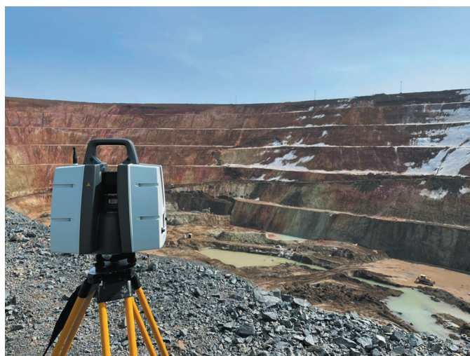
Мониторинг карьера с помощью лазерного сканера Leica ScanStation P50
