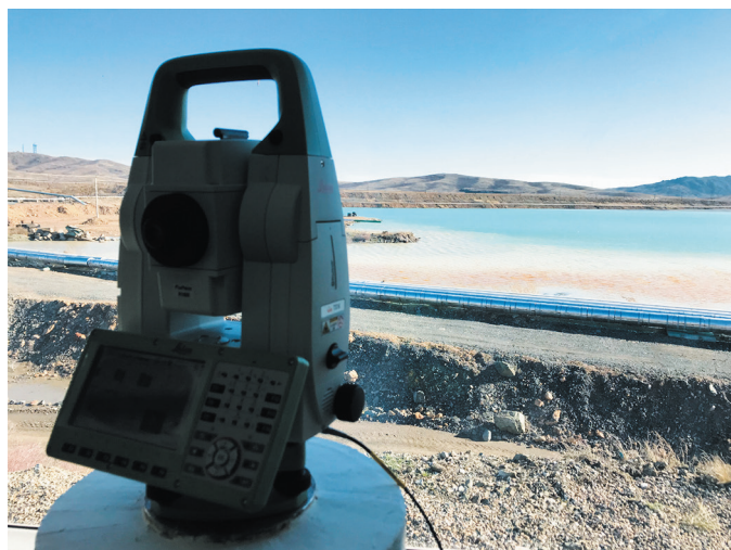
Геотехнический мониторинг с помощью роботизированных тахеометров
