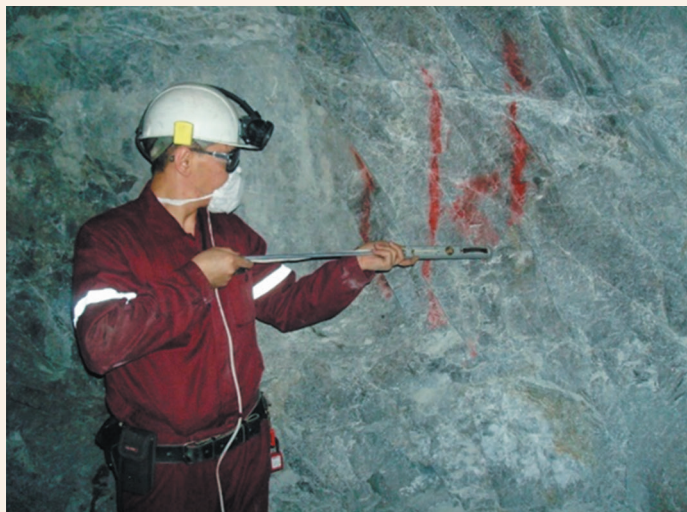
Сурет 1. Тау-кен соққыларын СБ-32 (М) Сапфир құрылғысымен өлшеу.
