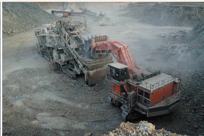
Сурет 2. Lokotrack MAF210 мобильді пластиналы қоректендіргішіне EX-3600E экскаваторымен кенді тиеу. Рис. 2. Погрузка руды экскаватором EX-3600E на мобильный пластинчатый питатель Lokotrack MAF210. Figure 2. Ore loading by excavator EX-3600E on mobile plate feeder Lokotrack MAF210.
