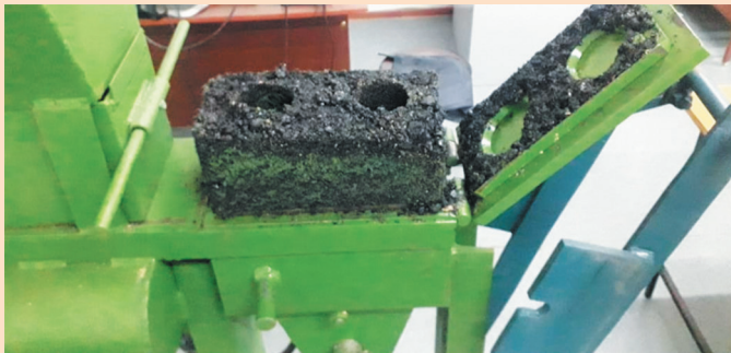
Рис. 3. Переносная установка полупромышленного изготовления брикетов.
