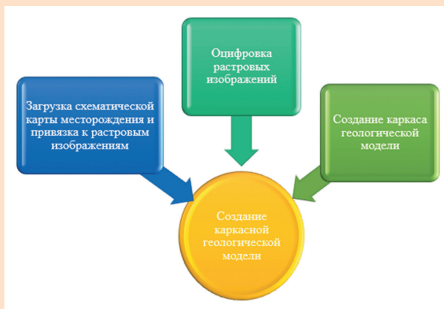
Рис. 2. Этапы создания каркасной литологической модели.
