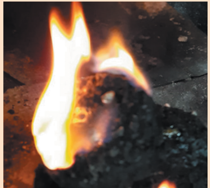
Рис. 4. Горение брикета состава уголь + гудрон + ПЭТФ.
