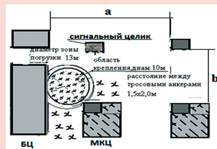
Рис. 7. Схема крепления кровли тросовыми анкерами в камерах погрузки руды и по трассе движения при отработке МКЦ.
