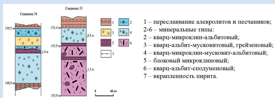
Рис. 2. Внутреннее строение пегматитовых жил месторождения Ахметкино.
