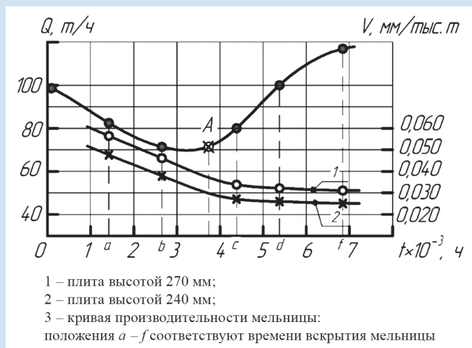
Рис. 2. Изменение производительности мельницы и скорости износа резиновой футеровки в процессе эксплуатации мельницы (СевГОК, Кривой Рог). Сурет 2. Диірмен өнімділігі мен диірмен жұмысындағы резеңке төсемнің тозу жылдамдығының өзгеруі (СевГОК, Кривой Рог). Figure 2. Change in mill productivity and rubber lining wear rate during mill operation (SevGOK, Kryvyi Rih).
