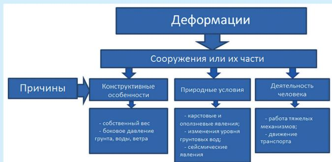
**Рис. 1. Причины деформаций сооружений.**
