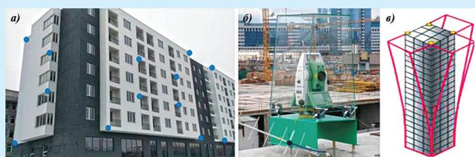
**Рис. 3. Расположение контрольных марок на объекте (а); мониторинг здания с применением роботизированного электронного тахеометра (б); общая схема GPS-мониторинга ветрового воздействия на высотное здание (в).**
