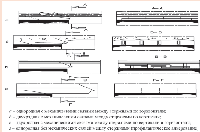
Рис. 2. Схемы химического анкерования неустойчивых пород кровли.
