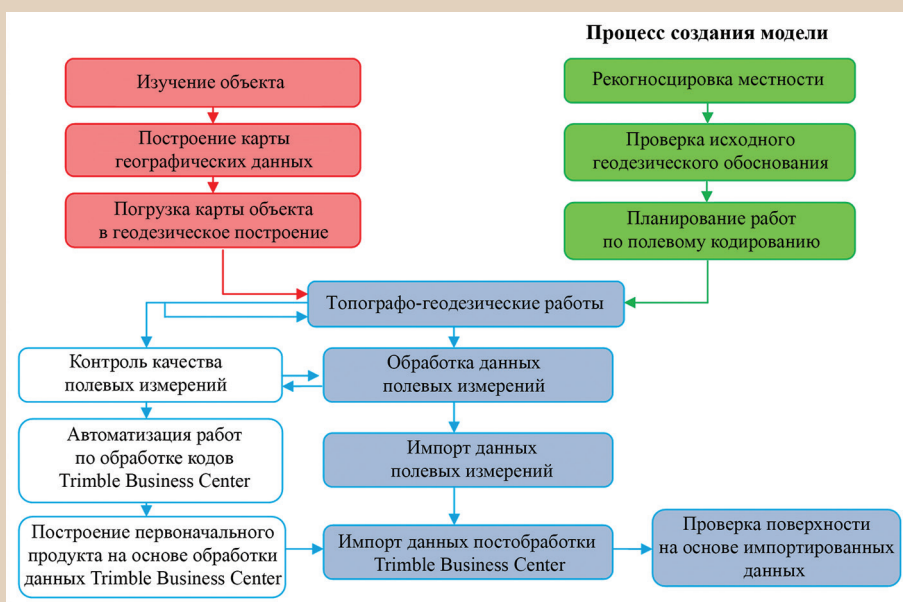
Рис. 2. Состав геодезических работ по созданию 3D модели местности.
