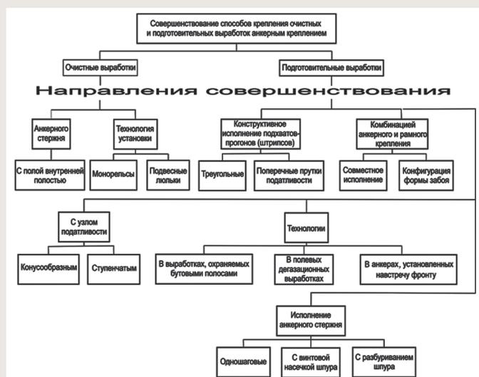
Рис. 6. Направления совершенствования анкерного крепления горных выработок.
