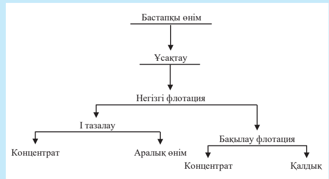
Сурет 4. Зертханалық эксперименттің принципті технологиялық сызбасы.
