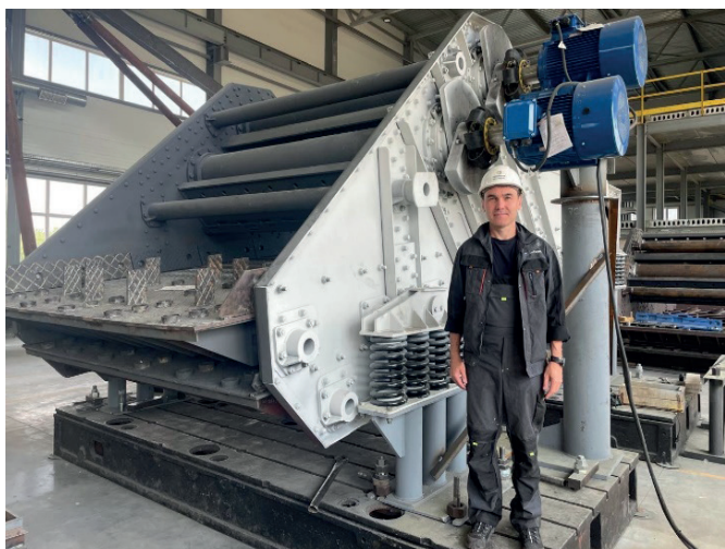
Рис. 3. Процесс обкатки самобалансного грохота.
