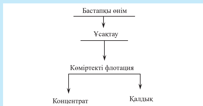
Сурет 2. Зертханалық эксперименттің принципті технологиялық сызбасы.
