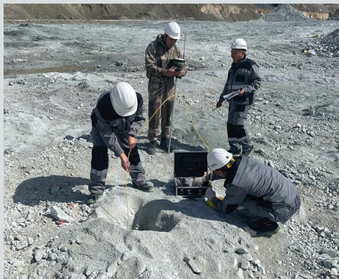
Рис. 2. Процесс исследования внутрискважинных трещин с помощью видеоинспекционного эндоскопа. Сурет 2. Бейне инспекциялық эндоскоптың көмегімен ұңғымалық жарықтарды зерттеу процесі.
