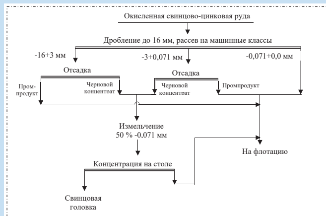
Рис. 1. Схема гравитационного обогащения. Сурет 1. Гравитациялық байыту схемасы. Figure 1. Scheme of gravity concentration.
