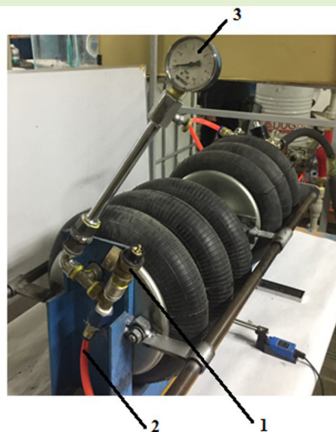
1 – предохранительный клапан; 2 – рукав для поддержания давления сопротивления; 3 – манометр.
