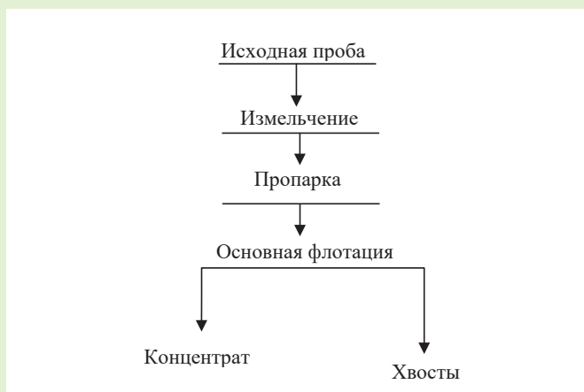
Рис. 3. Технологическая схема проведения лабораторных тестовых опытов. Сурет 3. Зертханалық сынақ тәжірибелерін жүргізудің технологиялық схемасы. Figure 3. Technological scheme of laboratory test experiments.
