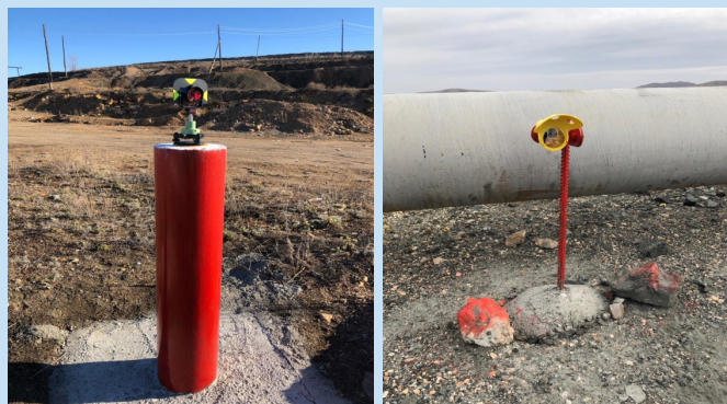
Рис. 2. Ориентирный пилон с отражателем (а) и рабочий репер с отражателем (б).
