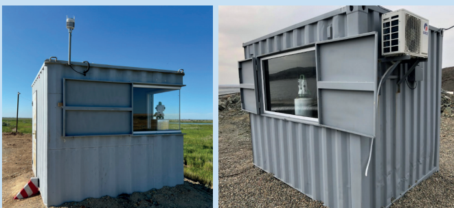
Рис. 4. Базовые станции автоматизированных систем наблюдений на дамбах обогатительных фабрик: Орловской (а) и Николаевской (б). Сурет 4. Автоматтандырылған бақылау жүйелерінің базалық станциялары байыту фабрикаларының бөгеттерінде: Орлов (а) және Николаев (б). Figure 4. Base stations of automated observation systems at the dams of processing plants: Orlovskaya (a) and Nikolaevskaya (b).
