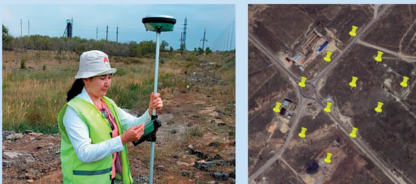
Рис. 4. Выполнение привязки (слева) и план опознаков в районе подработанной территории (справа) [составлено авторами].
