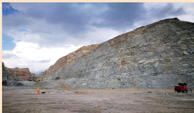
Рис. 1. Выполнение лазерного сканирования южного борта горным сканером на карьере.
