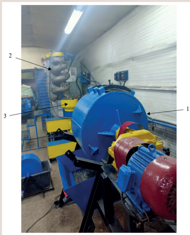
Рис. 1. Укрупненная технологическая установка 1 – мельница самоизмельчения; 2 – винтовой сепаратор;
