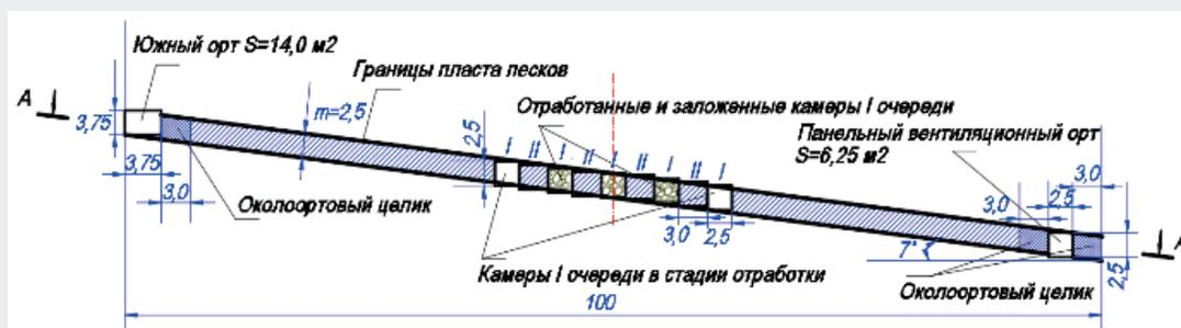
**Рис. 2. Конструкция камерной системы разработки с камерно-целиковой выемкой в криолитозоне.**
