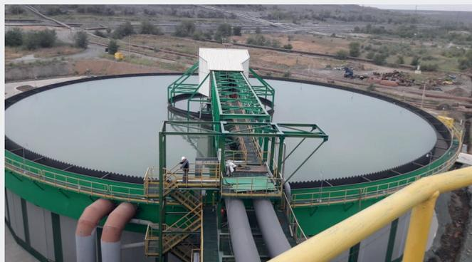
**Рис. 2. Высокоскоростной сгуститель HRT-62 на ЮГОКа.**
