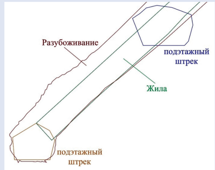
Рис. 1. Форма обрушения массива со стороны кровли при отработке маломощных залежей. Сурет 1. Жұқа кен шоғырларын игеру кезіндегі массивтің төбе тұсының опырылуының пішіні. Figure 1. The form of massif collapse from the side of the roof during the development of thin deposits.
