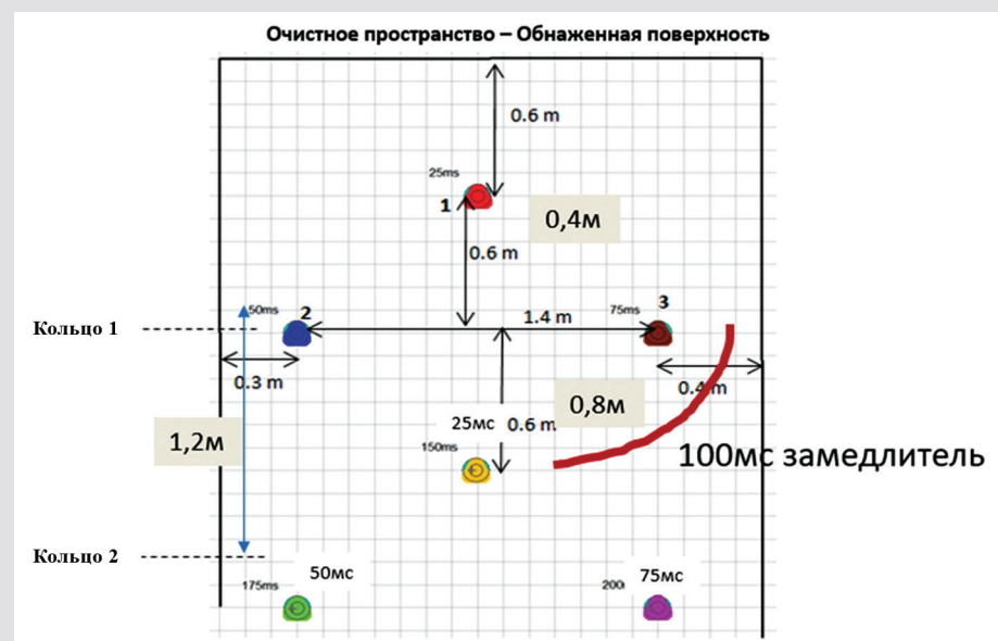
Рис. 3. Схема бурения маломощных рудных тел.
