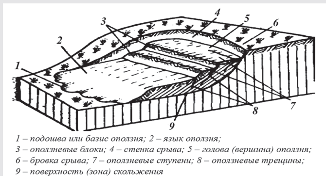
Рис. 1. Морфологические элементы оползня. Сурет 1. Көшкіннің морфологиялық элементтері. Figure 1. Morphological elements of the landslide.
