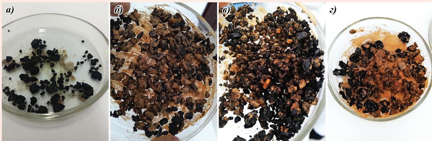
**Рис. 4. Покрытый ФФС спецкоке различных фракций: а – 0-6 мм; б – 10-25 мм; в – 0-10 мм; з – 25-40 мм.**
