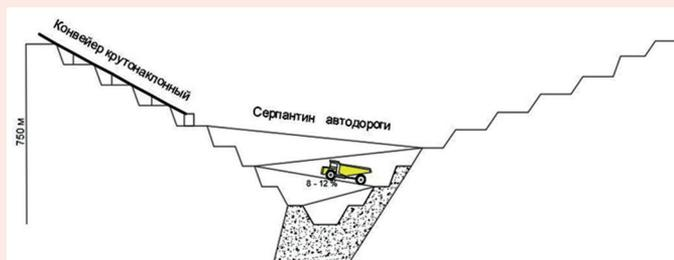
**Рис. 1. Обычная схема транспортировки руды из усеченного дна карьера с помощью обыкновенного автосамосвала.**
