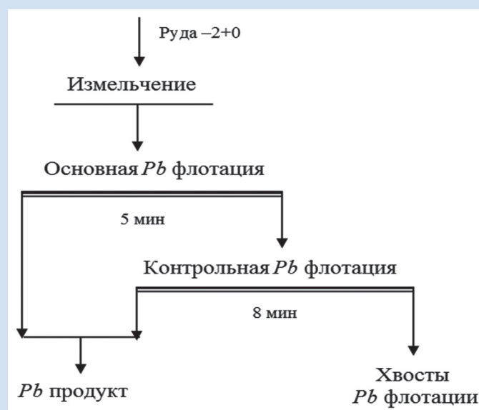
Рис. 1. Схема открытых опытов по отработке режима свинцового цикла.
