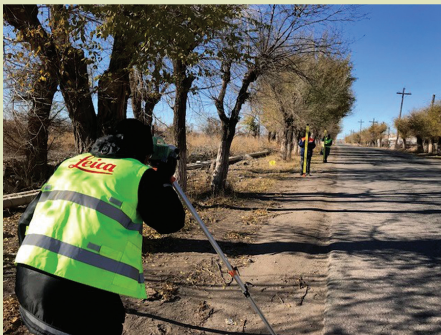
Рис. 1. Съемка рабочих реперов. Сурет 1. Жұмыс реперлерінің түсірісі. Figure 1. Shooting working reference points.
